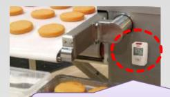
데이터로거를 PC와 분리한 다음,측정하고자 하는 곳에 위치시킵니다. (데이터로거가 안정적으로 측정 및 저장할 수 있도록 안전한 위치에 고정시키는 것이 좋습니다.)
